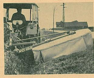
Beim Mähen der Böschung nach unten muß die Stange länger eingehängt und der Dreipunktbock mit der Hydraulik etwas angehoben werden.
