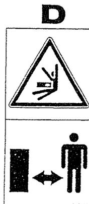
Ausreichenden Sicherheitsabstand zum Schwenkbereich der Maschine einhalten.
