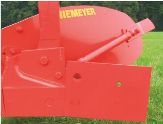
Um dem Pflug eine bessere Seitenführung zu geben, können unter bestimmten Voraussetzungen Anlageschoner montiert werden.
