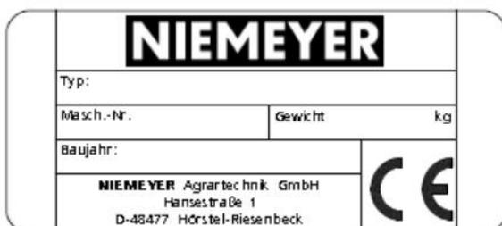
Das auf dem Typenschild angegebene Gewicht gibt Ihnen einen Hinweis für das erforderliche Hebezeug, wenn die Maschine angehoben werden muss. Dieses Gewicht kann sich jedoch durch die Verwendung von Zusatzausstattung erhöhen.
