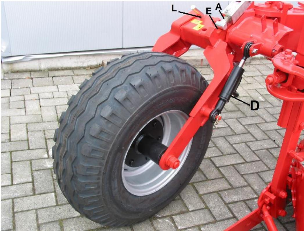
In Arbeitsstellung muss der Stecker immer in Bohrung L abgesteckt und mit einem Klapstecker gesichert sein. Auch der Zylinder ist nach obiger Abbildung anzubringen und zu sichern.
