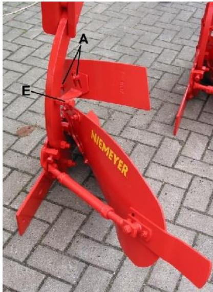
Der Stroheinleger ist über die Schrauben A in seiner Arbeitstiefe einstellbar und wird damit der Arbeitstiefe des Pfluges angepasst.
