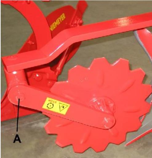
Die Arbeitstiefe (10 -15 cm) des Scheibensechs ist über die Schraube A in der Abbildung links einstellbar.
