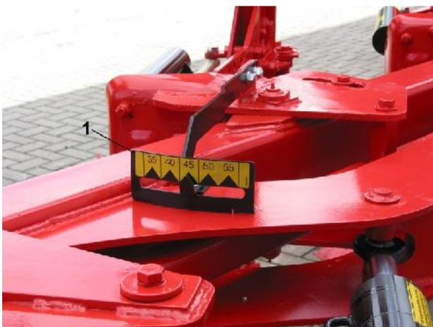
Abb. 5: Einstellung der Arbeitsbreite
